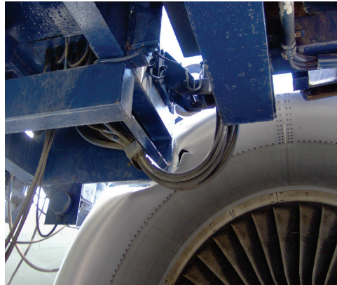
Слике 1.3 и 1.4 - Позиција места удара оплате мотора у авио мост.
