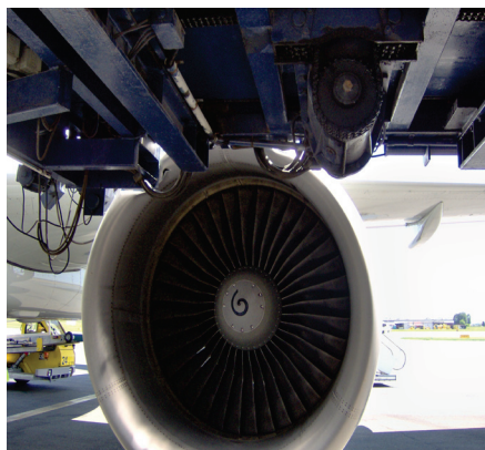
Слике 1.3 и 1.4 - Позиција места удара оплате мотора у авио мост.
